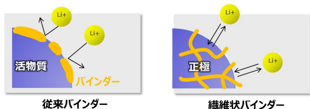
図2 バインダー構造によるイオンパスの確保
