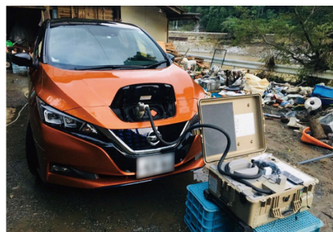
図3 日産リーフからの電力供給の様子
