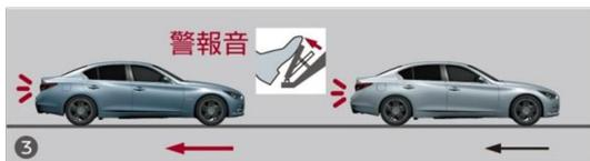
③ ドライバーによるブレーキ操作が必要だとシステムが判断した場合は、表示と音で警報し、アクセルペダルを押し戻す方向に力を発生させ、アクセルペダルからブレーキペダルへの踏みかえを支援します。
