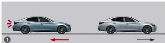
① 追従走行中の先行車が近づいたとき、アクセルペダルを戻すと、システムがなめらかにブレーキをかけて減速します。
