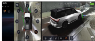
インテリジェントアラウンドビューモニター (2025年モデルイヤー QX80より) 3次元表示+ フード透過表示
