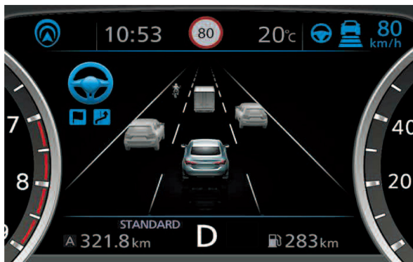
図-9 周辺車両のディスプレイ表示 Fig. 9 Surrounding vehicle display
