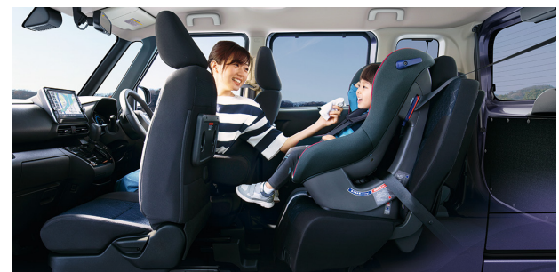
図-10 後席ロングスライド Fig. 10 Long-sliding rear seats
