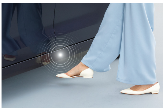
図-9 ハンズフリーオートスライドドア Fig. 9 Hands-free auto sliding door
