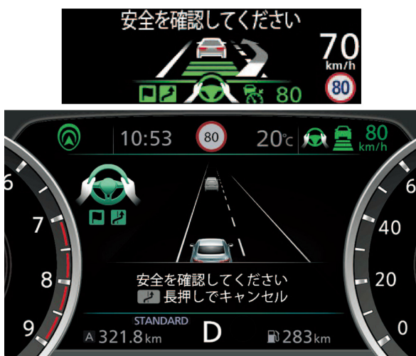
図-11 レーンチェンジ許可時のディスプレイ表示 Fig. 11 Lane change assist approved display
