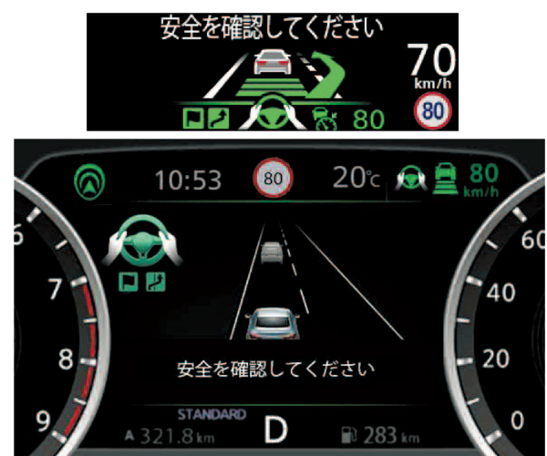
図-12 レーンチェンジ実行中のディスプレイ表示 Fig. 12 Lane change assist execution display
