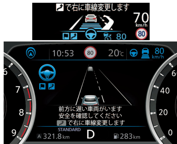
図-10 レーンチェンジ提案時のディスプレイ表示 Fig. 10 Lane change assist proposal display
