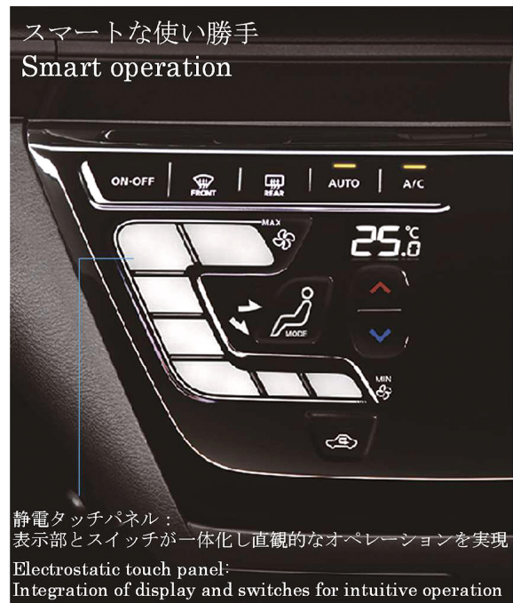
図-5 静電タッチパネル式オートエアコン Fig. 5 Electrostatic touch panel
