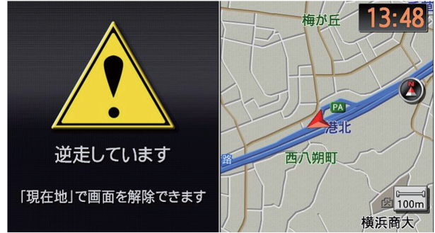
図-9 逆走報知中のナビゲーションモニタ画像 Fig. 9 Image of wrong-way going information
