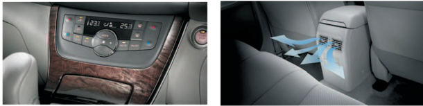
図-7 オートエアコン（左）とリヤベント（右） Fig. 7 Automatic air conditioner and rear air vents
