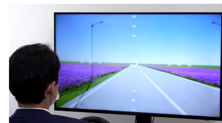
「交通安全未来創造ラボ」で開発した有効視野計測システム
