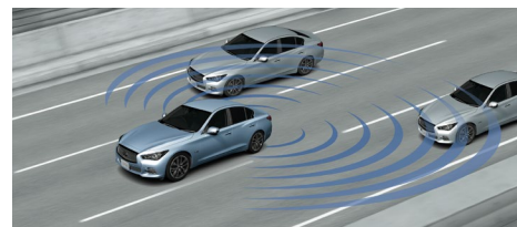
ブラインドスポットワーニングとブラインドスポットインターベンション
