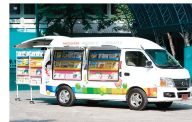
「アーバン」を改良し、絵本をたくさん積み込んだ「日産移動図書館」
