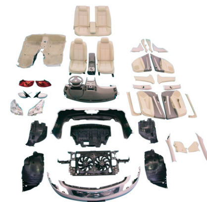
リサイクルしやすい構造や材料を採用している部品
