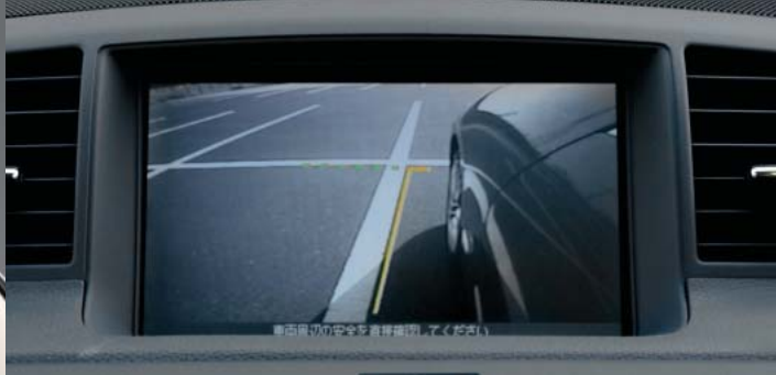
高感度赤外線 CCD カメラで、夜間でも車両の左前方をモニターに映し出し死角を減らす「サイドブラインドモニター」(フォーガ)
