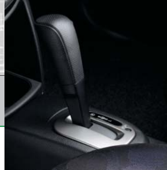
CVTは、変速ショックがなく、無段階に連続的に変速するため、スムーズなレスポンスと力強い走りが楽しめるとともに、低燃費で環境にもすぐれた変速機
