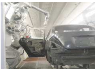
VOCが少ない水系塗装ラインへの切り替え (九州工場)
