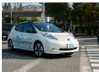
自動運転技術プロパイロット 公道走行実験
