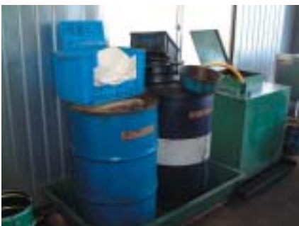
汚れを拭き取るためのウエスともれ防止のための受け皿
